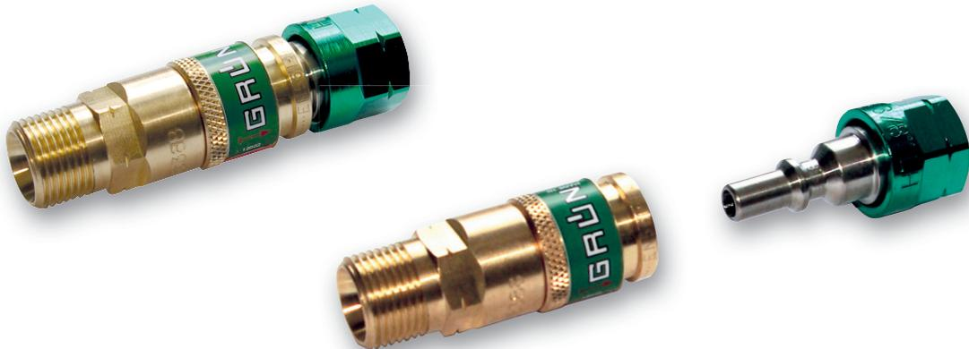
Die GRÜN Schnellkupplung nach EN 561 / ISO 7289 eignet sich zum sicheren und schnellen Verbinden der Schlauchleitung mit dem Arbeitsgerät. Beim Auskuppeln unterbricht die Gassperre der Schlauchkupplung automatisch den Gasfluss, so dass kein Gas unkontrolliert austreten kann.
